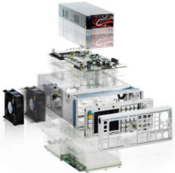
Custo total de propriedade reduzido: o número mínimo de módulos do R&S®SMC100A significa alta confiabilidade e fácil manutenção
