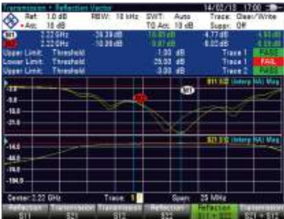
Análise de rede vetorial: Exibição simultânea de quatro parâmetros S ( S_{11} , S_{21} , S_{12} , S_{22} )
